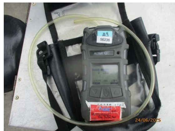
รูปที่ 3.1-1 (รูปที่ 58 Combustible Gas Detector)
